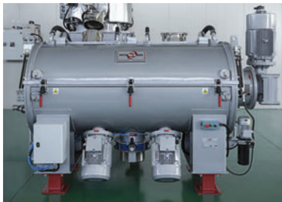
Combinando il turbomiscelatore TMX con il raffreddatore CMX, Promixon ha sviluppato il sistema Problend-TC per produrre dry blend a base di PVC, sia rigido sia plastificato, e WPC (Wood Plastic Composites) a base di PVC/PP/PE
