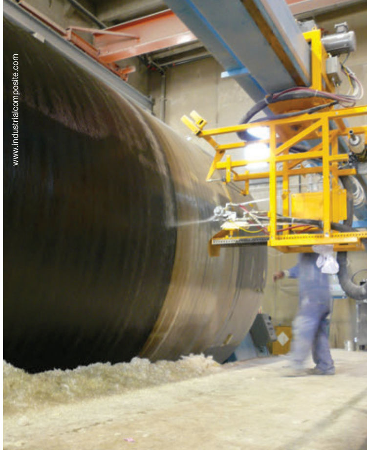
Produzione di serbatoi industriali utilizzando resine vinilestere rinforzate con fibre di vetro
