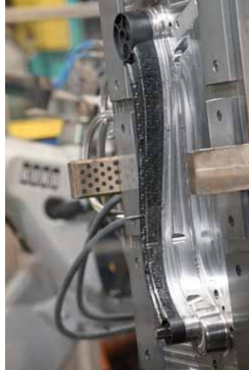
Il componente prodotto grazie al sovrastampaggio di inserti in termoplastico rinforzato con fibre continue (Tepex organic sheet)
