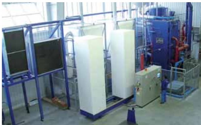
I benefici della configurazione verticale dello stampo consistono in densità uniforme e ridotta umidità residua nel blocco di EPS
