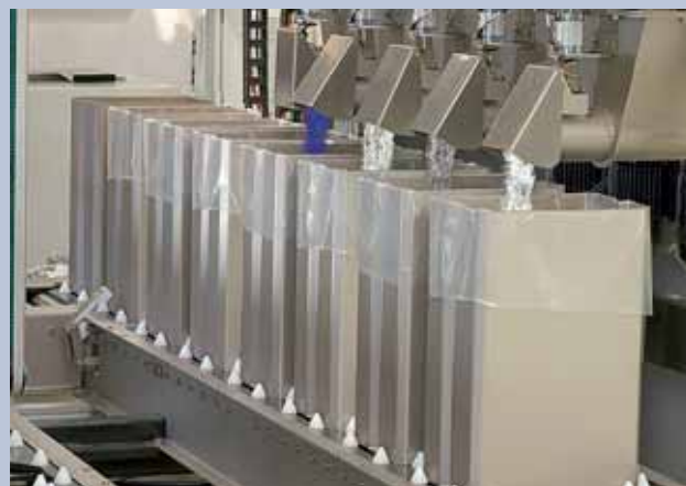
Nel sistema Supersincro i sacchetti vengono calzati su contenitori in acciaio inossidabile per essere riempiti con i prodotti dosati
