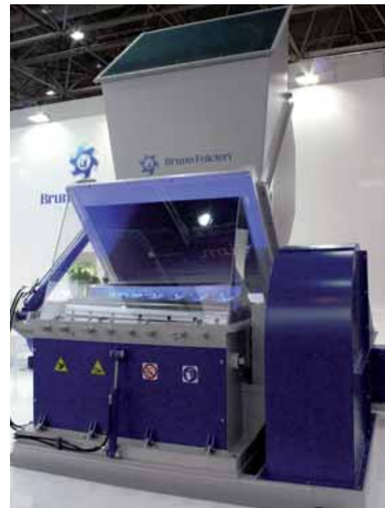
Il nuovo granulatore TOP 1500 D. 930 Easy Power è ottimizzato per assecondare produzioni intensive che richiedono elevate capacità di macinazione
