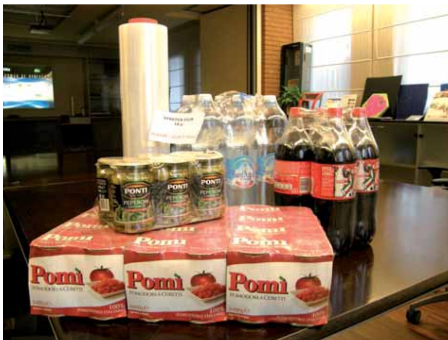
Il film estensibile sottile viene impiegato anche in sostituzione del film termoretraibile, per l'imballaggio di fardelli di bottiglie e contenitori di vario tipo, garantendo stabilità e protezione
