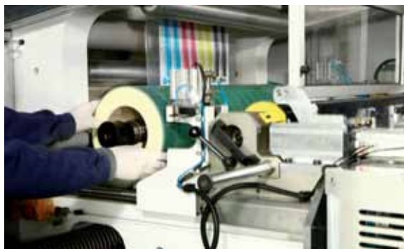
Sui gruppi di stampa della gamma Flexo sono stati adottati portacliché a manica con cambio rapido direttamente in macchina
