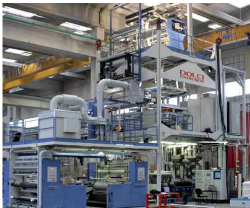
Dolci Extrusion realizza costantemente impianti per l'estrusione in bolla di film estensibile utilizzato principalmente, ma non esclusivamente, per il fardellaggio di rotoballe
