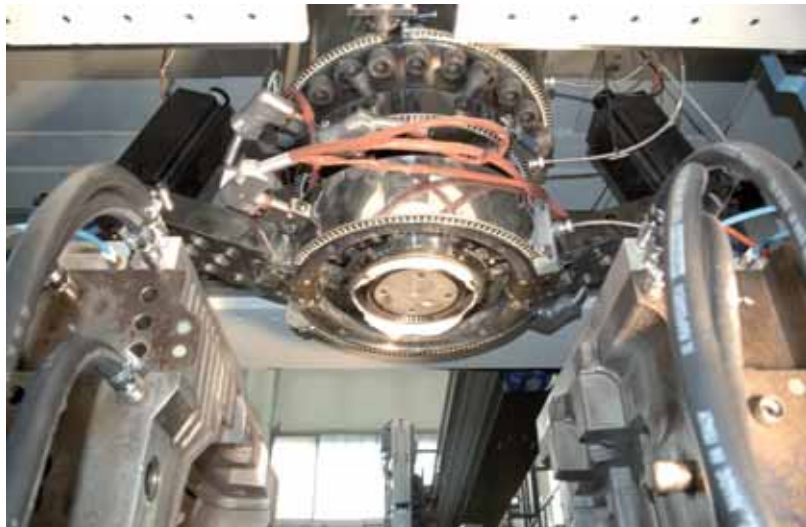
Il sistema Flex Ring per il controllo dello spessore radiale consente di regolare e uniformare lo spessore del parison e di ridurre il peso del prodotto finito
