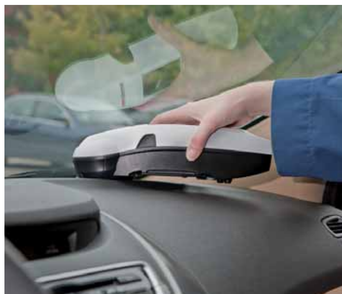
Lo spettrofotometro portatile 45G consente di rilevare colore e lucentezza simultaneamente con un semplice click
