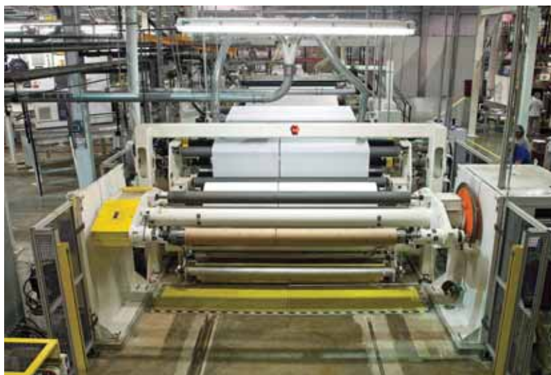
Per aumentare la propria capacità produttiva di film monouso, la brasiliana Cepalco ha commissionato a Davis-Standard una linea di estrusione a testa piana
