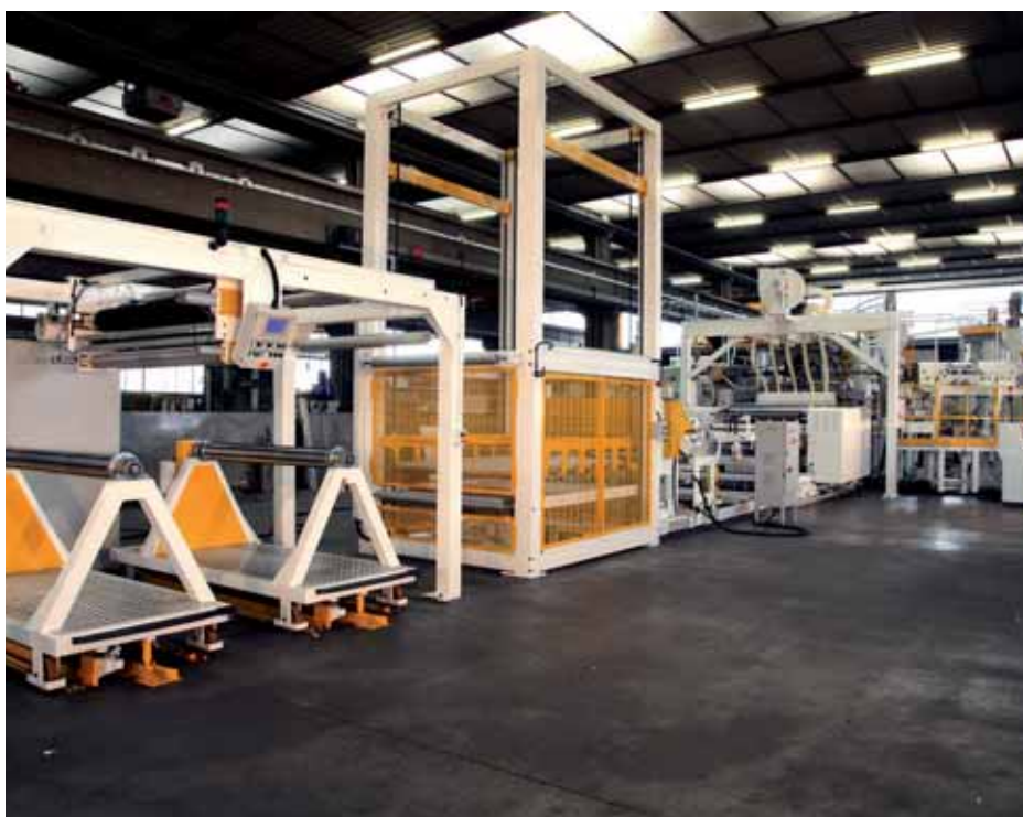
Per la produzione di carta sintetica a base di polipropilene, Union ha sviluppato speciali estrusori bivite
