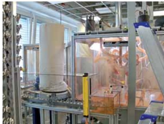
Il nuovo sistema tampografico sviluppato da Aigle consente di ottenere il giusto spessore dello strato di adesivo sulla superficie da trattare e un'accettabile resistenza all'abrasione della superficie floccata
