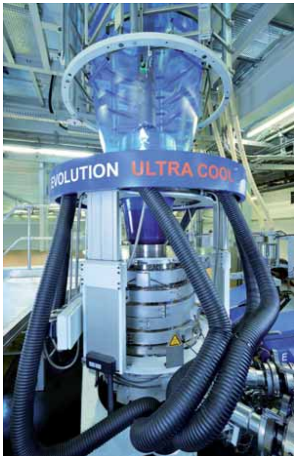
Il sistema di raffreddamento Evolution Ultra Cool migliora la resa produttiva degli impianti per l'estrusione di film in bolla grazie a facilità di utilizzo e prestazioni elevate
