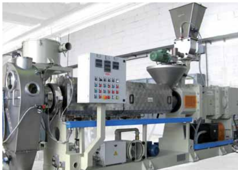
L'estrusore svolge una funzione fondamentale per conferire ai compound medicali un corredo di caratteristiche in grado di garantire la necessaria qualità dei prodotti finali
