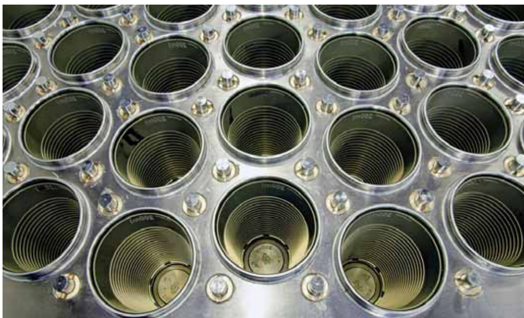
Un dettaglio della disposizione a quinconce delle cavità nello stampo per bicchieri realizzato da Termostampi
