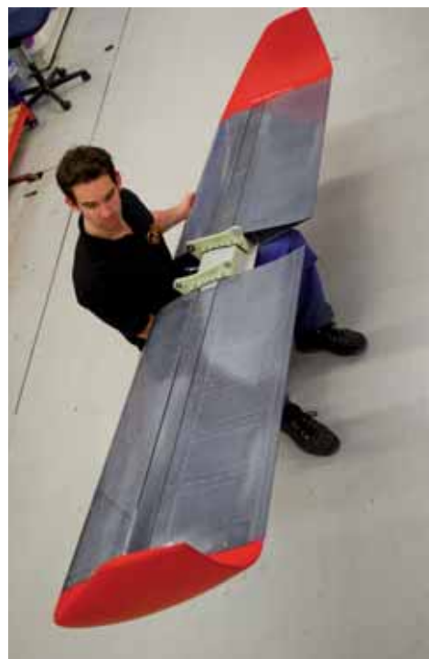
La società olandese Fokker Aerostructures - insieme ai partner: AgustaWestland (Italia), TenCate Advanced Composites (Olanda) e Ticon (Germania) - ha realizzato il primo leggerissimo stabilizzatore interamente in composito termoplastico sviluppato e messo in produzione per un elicottero
