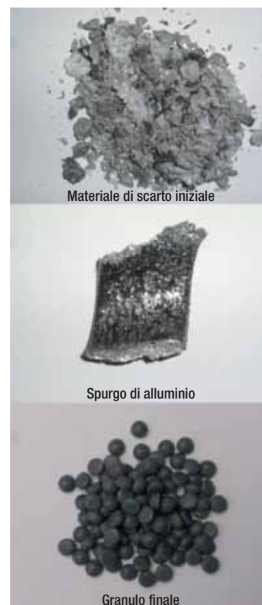
Esempio di lavorazione di materiale proveniente da tubi in polipropilene con inquinamento fino al 18% di particelle d'alluminio, con filtro ERF 200/150 \mu e perdita di materiale pari al 7%
