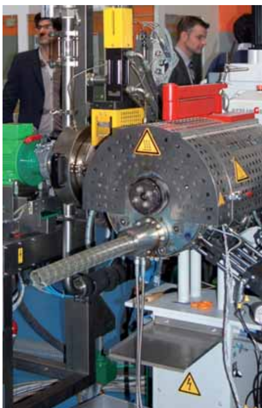
Il filtro rotante continuo ERF con l'uscita del materiale di scarto solidificato
