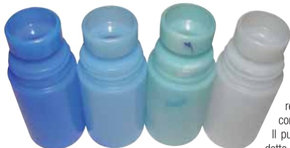
Pulizia di un flacone per medicinali con il purging compound Ultra Plast PO
