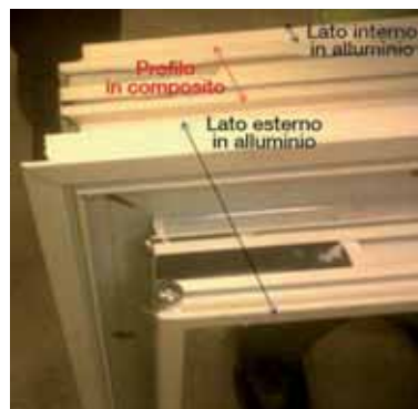
Il pannello Cofahe di Owens Corning consente di sostituire i tradizionali profilati in alluminio/poliammide con quelli in vinilestere pultruso rinforzato con fibre di vetro Xstrand H, aventi migliori proprietà meccaniche e di isolamento termico
