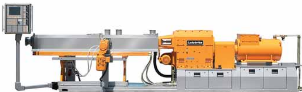
Modularità ed efficienza: il binomio che più contraddistingue l'estrusore ZSE 60 Maxx
