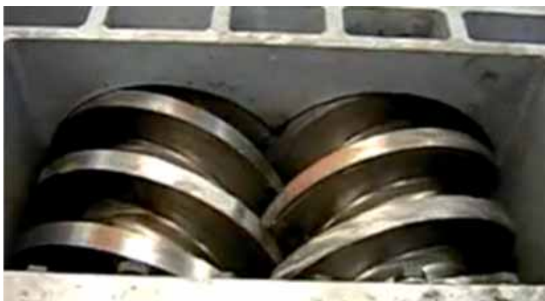
Nel plastificatore con viti rotanti di ampio diametro il materiale viene sottoposto a frizionamento e riscaldamento, che ne riducono l'elevata umidità e ne aumentano la densità
