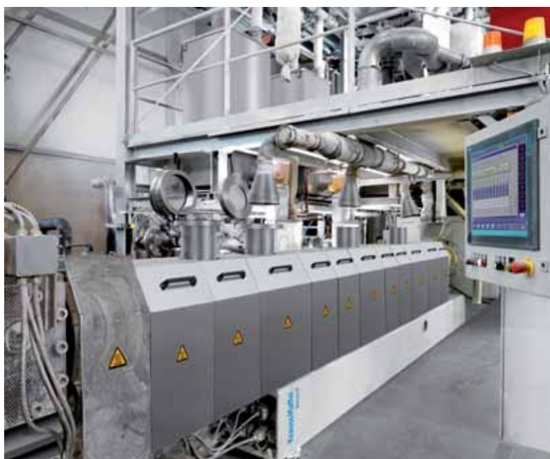
Tempo di residenza prolungato e ridotta sollecitazione di taglio, rendono il modello ZE 90 UT x 56 D, con ampio volume libero, particolarmente indicato per compound altamente carichi
