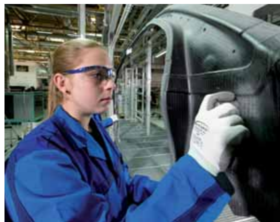
Per ridurre il peso del veicolo e far posto alla batteria del motore elettrico, il team "BMW i" ha progettato la prima carrozzeria monoscocca integrale realizzata specificamente per la produzione in serie di vetture elettriche
