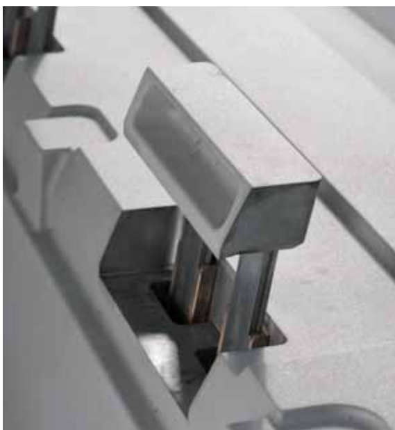
Implementando e utilizzando moduli e inserti removibili è possibile realizzare componenti caratterizzati da sottosquadra
