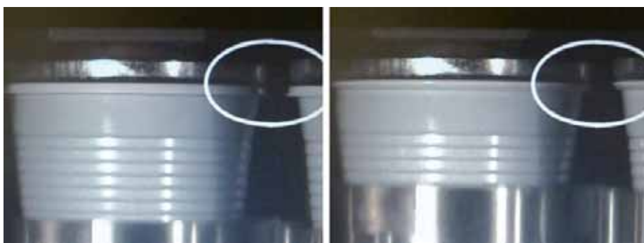
Bicchieri prima (a sinistra) e dopo (a destra) la bordatura con il sistema installato sulla termoformatrice F33 di OMV
