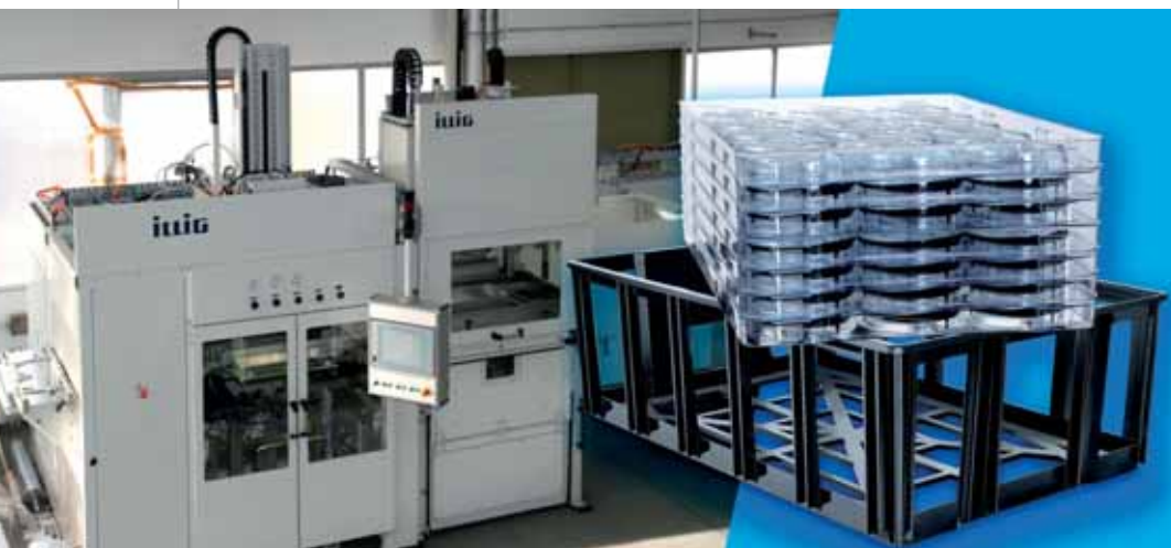
Coperchio e interni della cassetta Varioboxx sono ottenuti tramite termoformatura con una macchina della gamma UA di Illig
