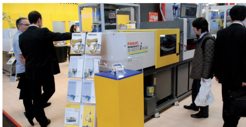
Il modello S-2000i-30B utilizzato per la produzione di piccoli ingranaggi per orologi
