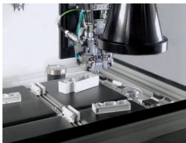
L'uso di ottiche ad alte prestazioni nella cella di erogazione Smart - DM 402 riconosce automaticamente componenti con diverse dimensioni e forma disposti casualmente sul nastro trasportatore
