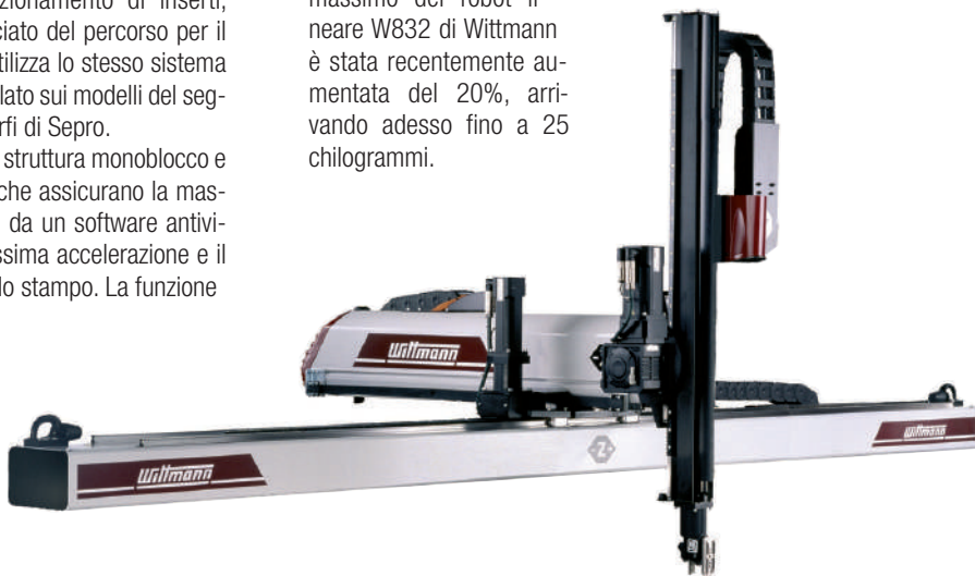
Il carico massimo del robot lineare W832 è stato portato a 25 chilogrammi, che diventano 35 grazie a una configurazione opzionale del braccio verticale
