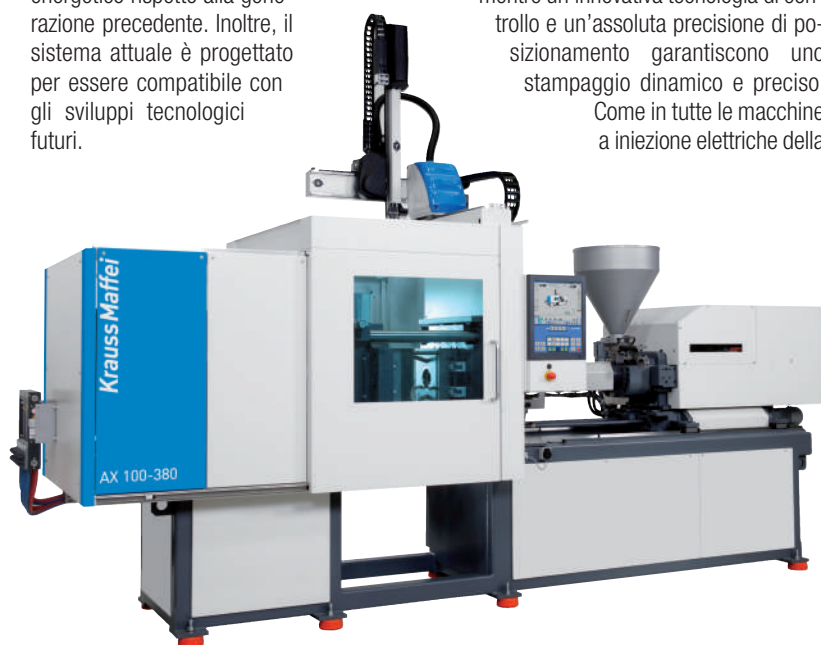
Il modello AX 100-380 è alla base dell'isola per la produzione di raccordi a T in polipropilene destinati al settore edile
