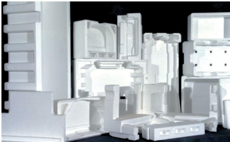
Esempi di imballaggi in EPS per mobili e componenti d'arredo
