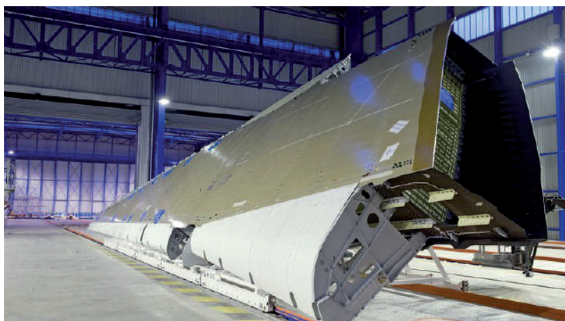
L'ala dell'A350 XWB è interamente realizzata in materiale composito (Foto: Airbus/H. Goussé)
