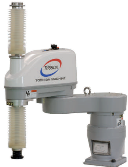
Modello di robot TH adatto all'impiego in camera bianca
