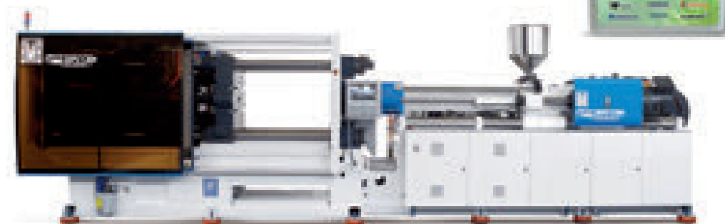
La macchina a iniezione eKW28Pi/1300 full electric che BMB espone a Friedrichshafen e, più in alto, il coperchio del contenitore che verrà stampato in fiera, etichettato tramite IML
