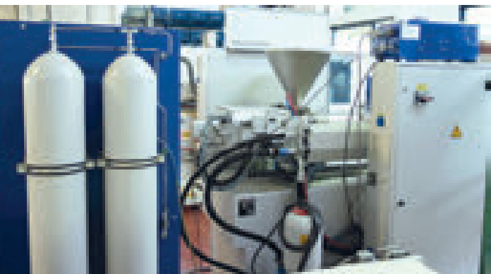
Al fine di raggiungere una velocità d'iniezione elevata che favorisca una distribuzione omogenea dell'espanso, il pacchetto CellMould viene fornito con un accumulatore d'iniezione in dotazione
