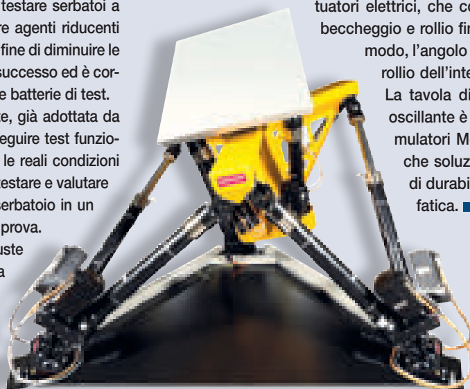
La tavola per testare il comportamento dei liquidi all'interno dei serbatoi auto simulando le reali condizioni stradali
