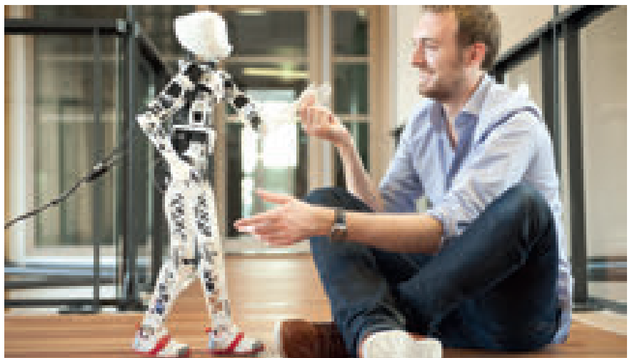
Ideato dai ricercatori dell'Inria Flowers Team, Poppy è un "robot bambino" le cui parti in plastica sono interamente stampate in 3D usando poliammidi o PLA (Foto: Inria/H. Raguey)
