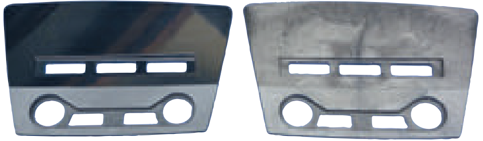
Il confronto tra componenti lavorati con e senza raffreddamento dinamico dimostra quanto la termoregolazione dinamica dello stampo possa influire sulla qualità superficiale del manufatto
