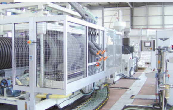
El corrugador F1200SH10 permite actuar sobre tubos de hasta 1000 y 1200 mm de diámetro interno y externo respectivamente
