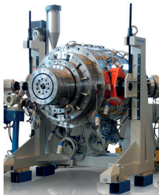
El cabezal Venus Multi 3 1200, de tres espirales, ha sido considerado la mejor opción para la extrusión de tubos multicapa con materiales HSCR (High Stress Crack Resistant)
