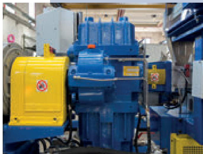
Dettaglio di una macchina, con il riduttore in evidenza
