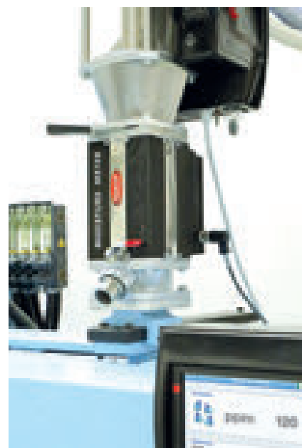
Il sistema Moisture Meter installato sulla macchina di processo
