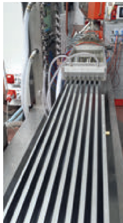
Linea per la produzione di profili per rottura ponte termico
