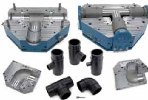
Molde com matrizes e machos intercambiáveis para produção de acessórios e uniões de vários diâmetros e dos respectivos cotovelos de polietileno
