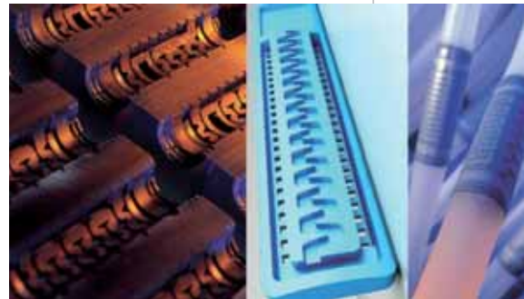
A Profile Dies lançou uma linha capaz de inserir até 800 gotejadores planos em tubos para irrigação
