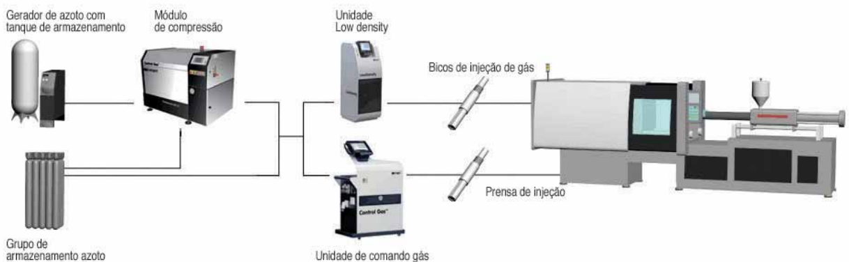
Exemplo de sistema de moldagem por injeção assistida a gás (Fonte: CGR System)
