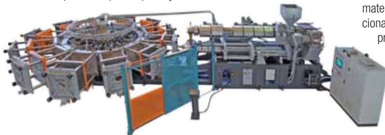
A prensa rotativa por injeção Roto E 1000/12 de 12 estações de trabalho
