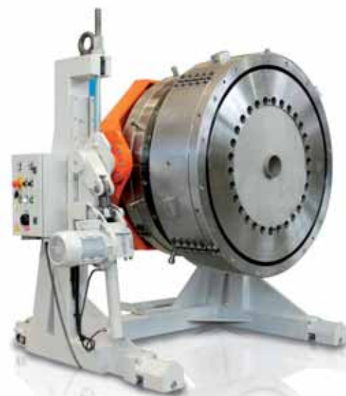
Uma cabeça da gama Venus, desenvolvida pela Tecnomatic para a extrusão de tubos de grande diâmetro
