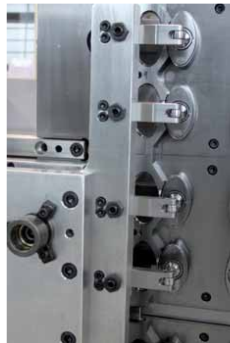
Detalhe do molde para a realização de tampas "flip top"
