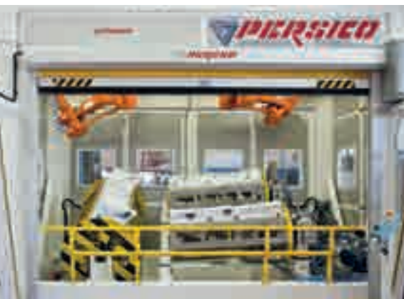
Sull'innovativo sistema Eco-cut sviluppato da Persico per il taglio automatico dei rivestimenti interni per autovetture sono installati due robot antropomorfi ABB modello IRB 2400/16
