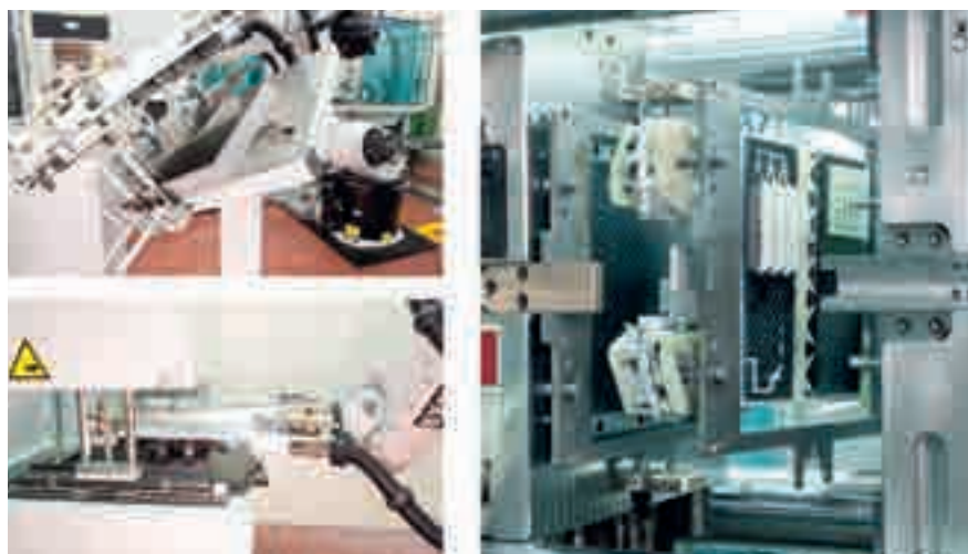
Fig. 2 - Alimentatore, stazione di caricamento e stampo nella cella di produzione
