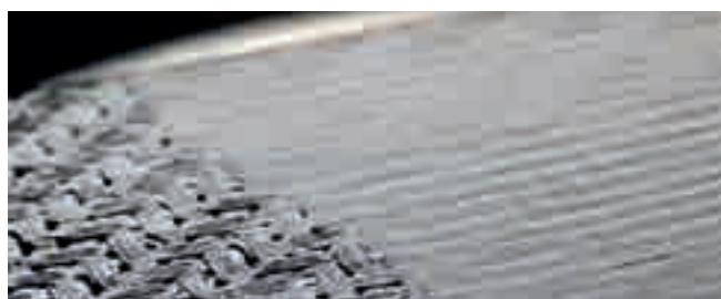
Fig. 3 - Processi RPM e TSF: a seconda del processo adottato, le resine vengono lavorate inizialmente sottoforma di polvere (A.S.SET-Powder, a sinistra) o di lastre semilavorate con rinforzo di fibre continue (A.S.SET-Sheets, a destra). Riscaldata, la matrice polimerica fonde favorendo la lavorazione successiva
