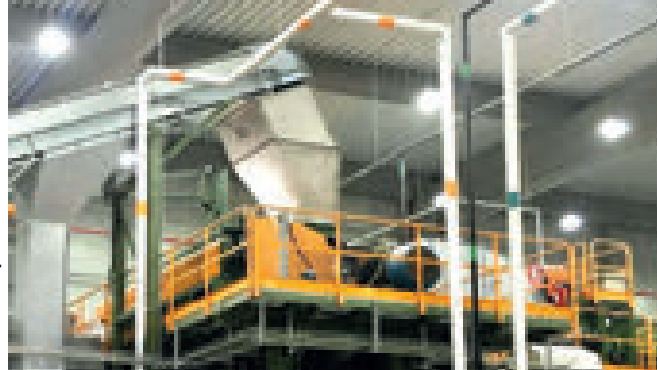
Новый процесс предварительной мойки, разработанный компанией Sorema, обеспечивает возможность переработки чистых бутылок без этикеток и остатков капель, свойственных традиционному процессу
