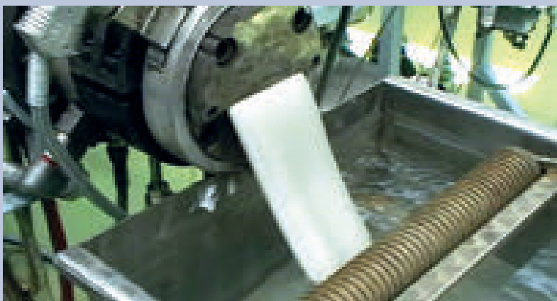
Компания Maris разработала инновационную систему девулканизации резины при помощи двухшнекового экструдера с однонаправленным вращением в полностью термомеханическом процессе без применения химических агентов.
