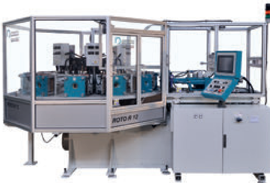
Модель Roto R, представленная в действии на K 2016, оснащенная пресс-формой для производства уплотнительных колец
