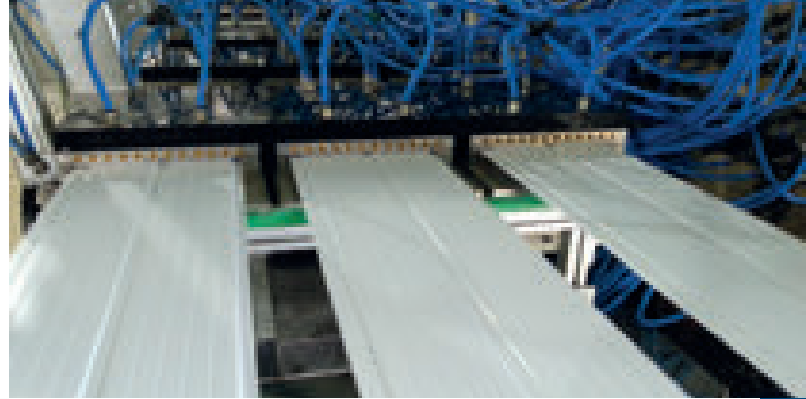
Экструдер с тройным выходом использует все производственные мощности двухшнекового экструдера MD 75/30
