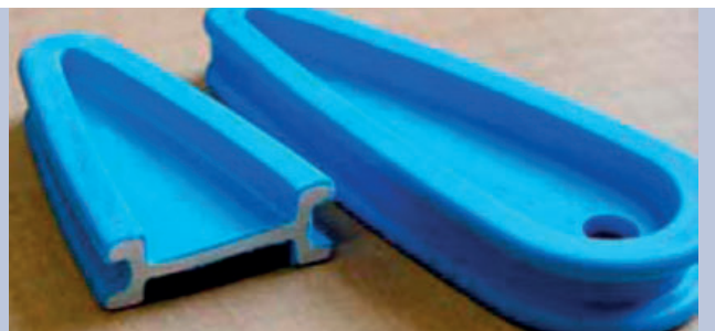
Con il sistema Twinshot il manico di una spazzola, precedentemente realizzato tutto in HIPS nero resistente all'urto, può essere prodotto con anima in HIPS e rivestimento esterno in elastomero termoplastico "soft touch"
