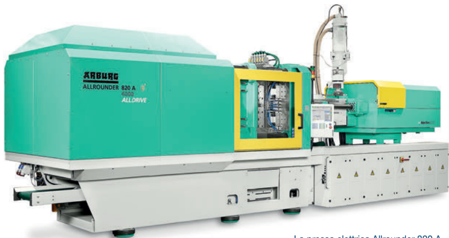
La pressa elettrica Allrounder 820 A dà dimostrazione della produzione economicamente vantaggiosa di 24 coltelli e forchette in circa 5,5 secondi.
