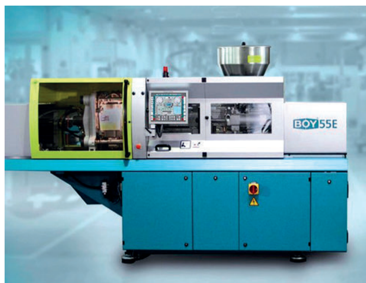
Il modello 55 E, dotato di servoazionamento, è in grado di garantire un'efficienza energetica di classe 8+, secondo lo standard Euromap 60.1
