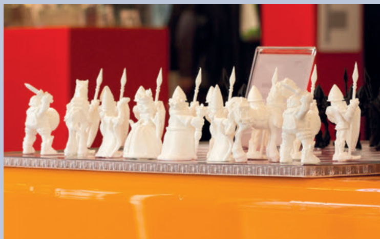
Un set di scacchi in PLA Ingeo - prodotto grazie alla stampa 3D ed esposto recentemente in alcune fiere di settore da Materioteca - dimostra la finezza dei dettagli ormai raggiungibili
