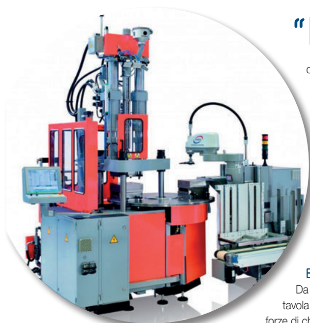
La pressa verticale da 60 t con tavola rotante (modello RT-60) equipaggiata con automazione (robot tipo Scara) per il carico e lo scarico dei pezzi
