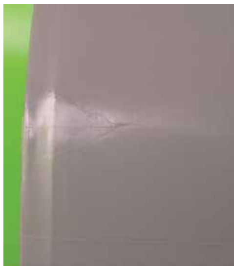
Figura 1 - Immagine della zona terminale di riempimento del pezzo con evidenti segni di linee di flusso
