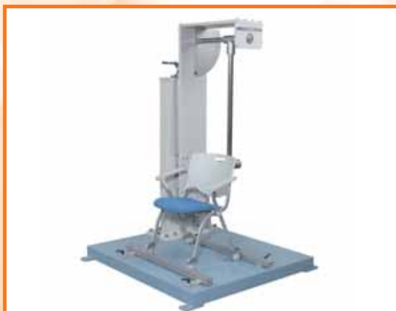
Figura 3 - Prova d'urto sullo schienale di una sedia da ufficio
