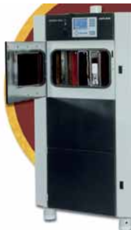
Figura 2 - Camera climatica con lampada allo xeno per prove d'invecchiamento che simulano l'esposizione alla luce del sole e alle diverse condizioni climatiche (temperatura e umidità)
