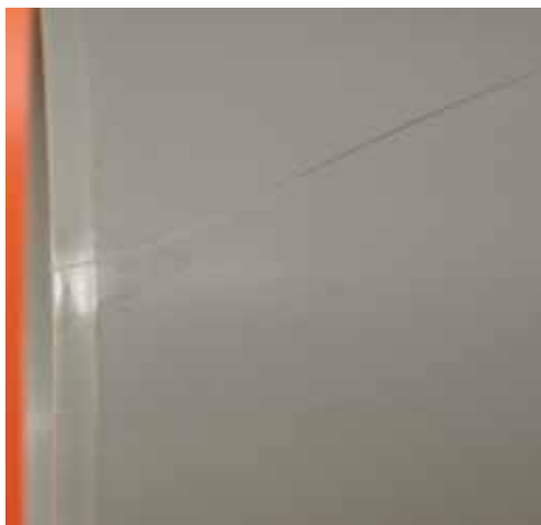
Figura 2 - Immagine della zona terminale di riempimento del pezzo con rottura evidenziata
