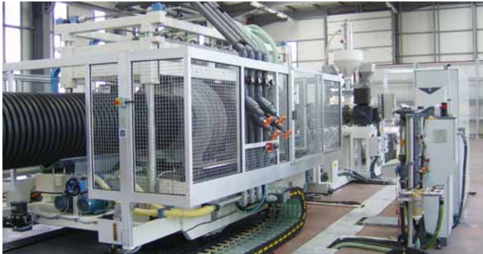
Itib Machinery公司开发的采用往复技术的波纹管成型机
