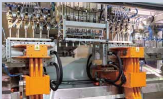
PB10E/DXL吹塑机挤出模头设计成能够高度控制挤出机型坯,并可在半小时内更换颜色
