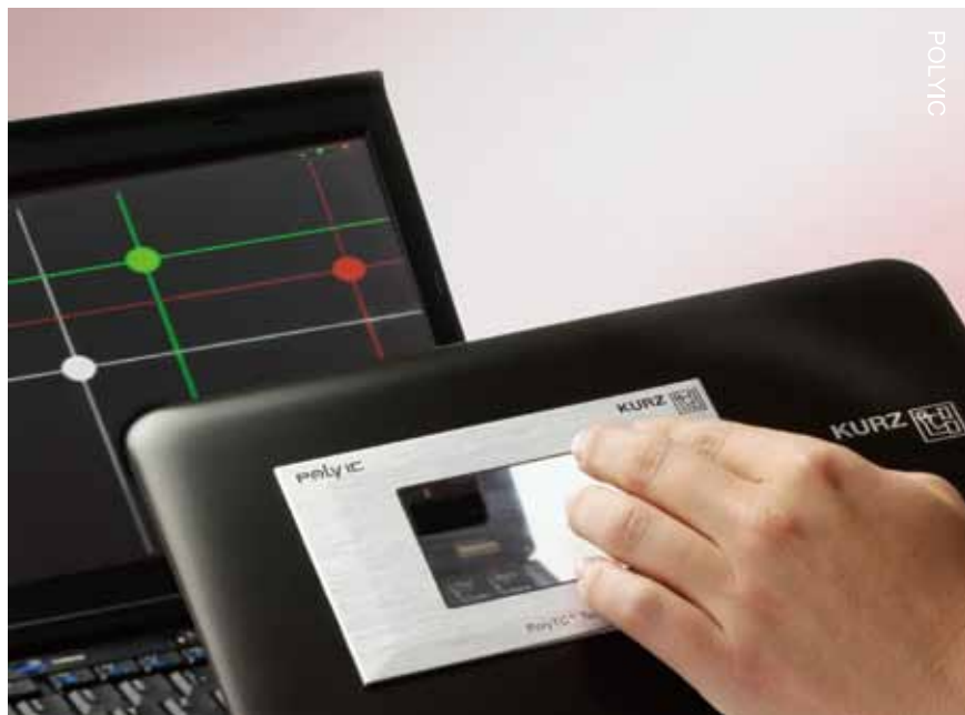
具有透明、导电覆盖膜的电容式多点触摸传感器领域的演示
