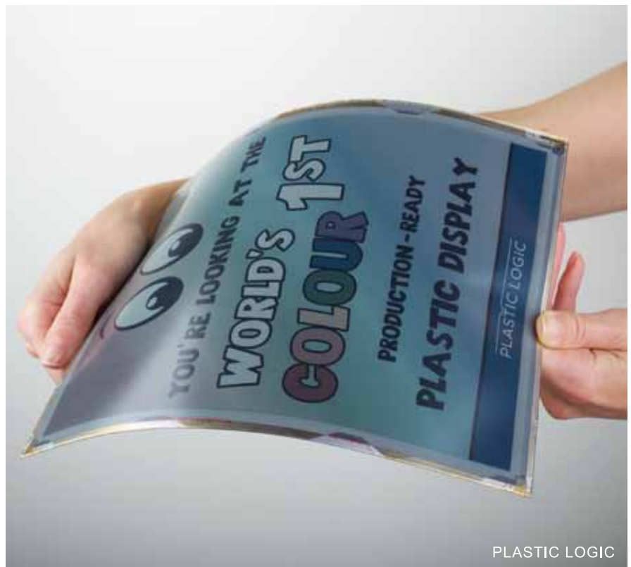
供电子阅读器和平板电脑用的柔性电泳彩色显示屏，配备有机电晶体背板 - OTFT
