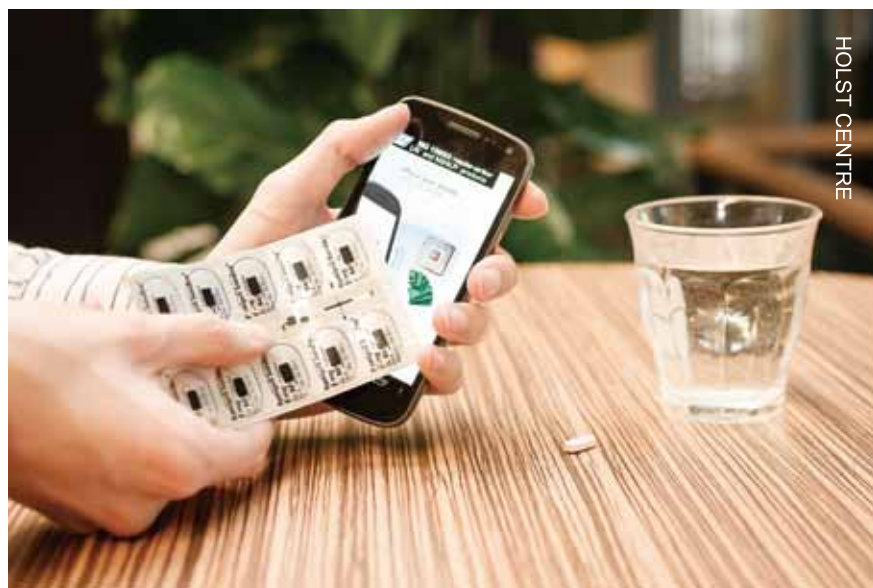
药品的智能包装, 置有智能手机可读的数据存储器
