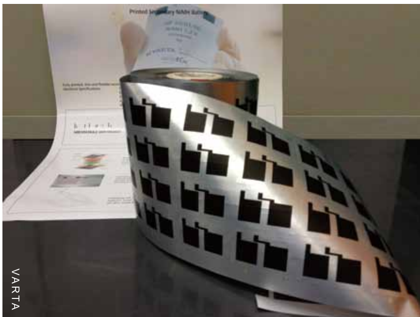
平板电池 (镍金属氢化物) 从卷轴印于薄片上
