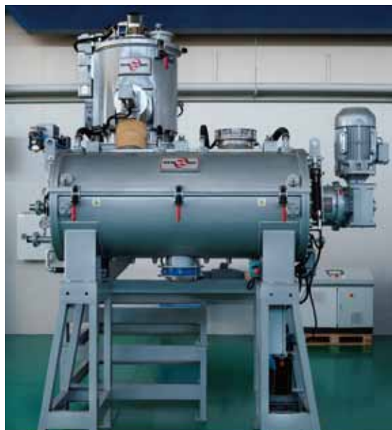
TMX:滑轮混料机及CMX冷却器
