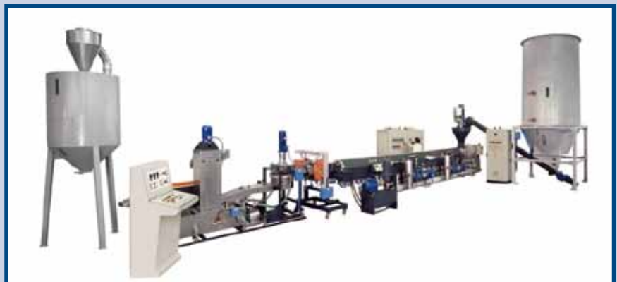
新型E130/54D - FTTC Double Vent型号有配备有料仓和强制供料系统, 用于回收LDPE、HDPE或PP废薄膜的款式, 或配有料斗用于加入粉碎废料的款式
