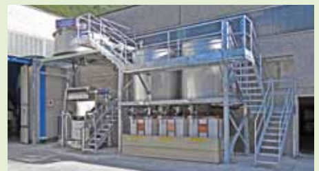
污水处理/循环利用系统, 以25立方米/小时的能力, 处理塑料挤出时的脱气水
