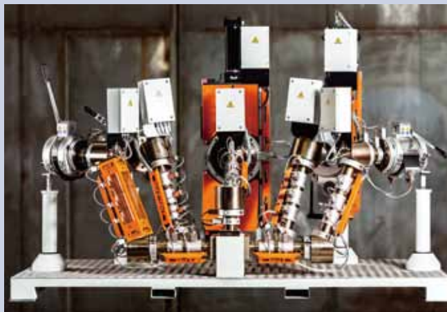
对于5层流延挤出生产线，BD Plast公司开发了一组预装在一个专用平台上的管件和肘管，每一个都配备有不同的单板换网器
