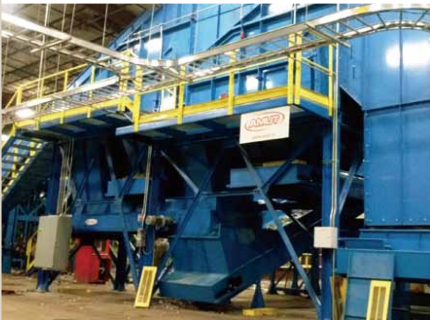
Amut公司分选和预清洗系统的Elliptical Ballistic Separator
