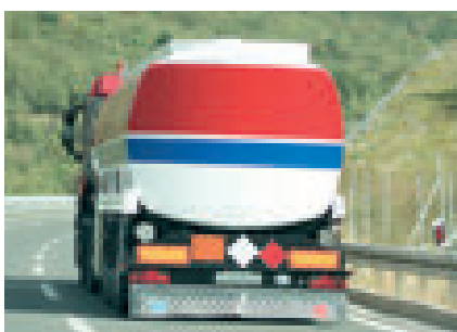
Serbatoi e cisterne per il trasporto dei fluidi vengono prodotti sempre più spesso in materiale composito; in genere si tratta di poliestere rinforzato con fibra di vetro
