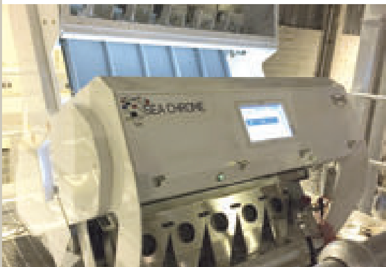
La selezionatrice SEA Chrome è in grado di vedere come l'occhio umano grazie alla tecnologia Full-Colour RGB, che riconosce fino a 16 milioni di singoli colori
