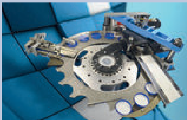
Con la nuova macchina di Gefit è possibile assemblare fino a centomila capsule con liner all'ora
