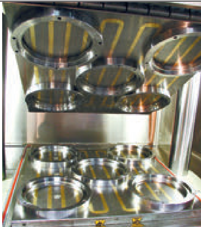
Il sistema brevettato Gemini garantisce un ancoraggio rapido e sicuro degli stampi sulle presse per lo stampaggio di gomma e TPE
